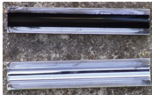
Bild 5: Halbschalen zur Bestimmung der Detonationszellbreiten (obere Halbschale berußt)
