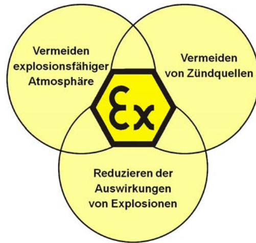
Bild 3: Die Maßnahmen des Explosionsschutzes werden in drei Teilaspekte gegliedert: Das Vermeiden explosionsfähiger Atmosphäre, das Vermeiden von Zündquellen und das Begrenzen der Auswirkungen von Explosionen auf ein unbedenkliches Maß
