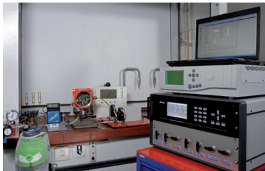
Bild 4: Prüfvorrichtung zur Ermittlung der Kalibrierfunktion eines Gas-Transmitters
